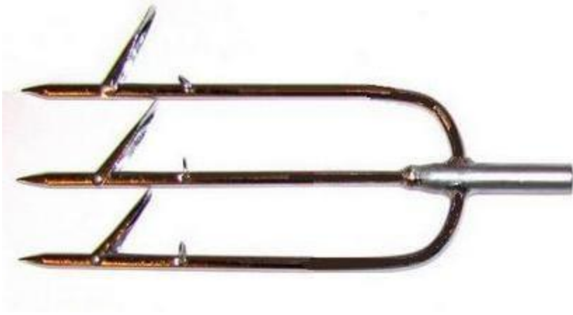
Острога, сделанная по принципу поворотного гарпуна.
